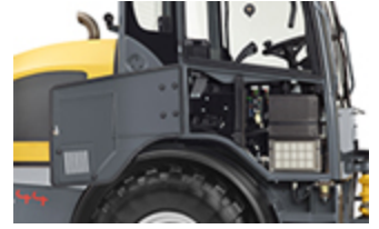
Servisní klapka na vnějším plášti komfortní kabiny řidiče
