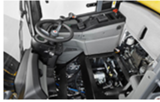
Údržbové přístupy do vnitřku kabiny řidiče
