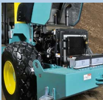
Kompaktní obestavení motoru a motorových komponentů
